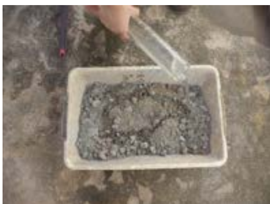
Figura 2. Mistura de RCC, cimento, areia e água recolhidos.
