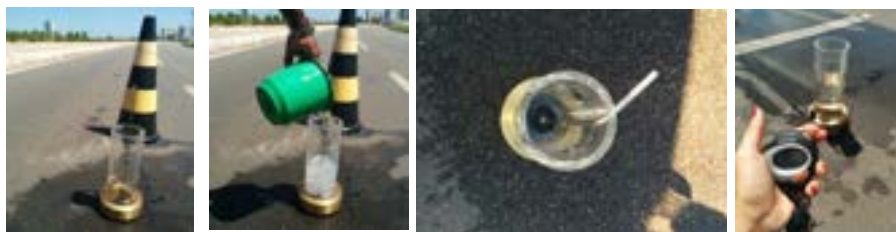
Figura 2. Equipamentos e realização do ensaio de drenabilidade.
