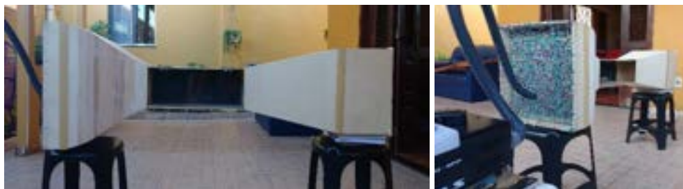
Figura 4. Mini Túnel de Vento construído. Fonte: Próprio autor.
