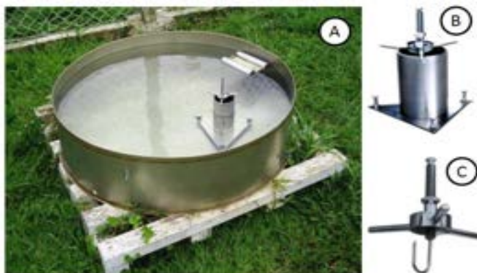
Figura 1. Tanque Classe A (A); poço tranquilizador (B); parafuso micrométrico (C).
