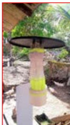
Figura 1. Armadilha de CDC utilizada para captura de insetos, uma luz atrai o inseto que é capturado ao ser sugado por um pequeno ventilador e preso dentro de uma rede, município de Imperatriz, estado do Maranhão 2016.
