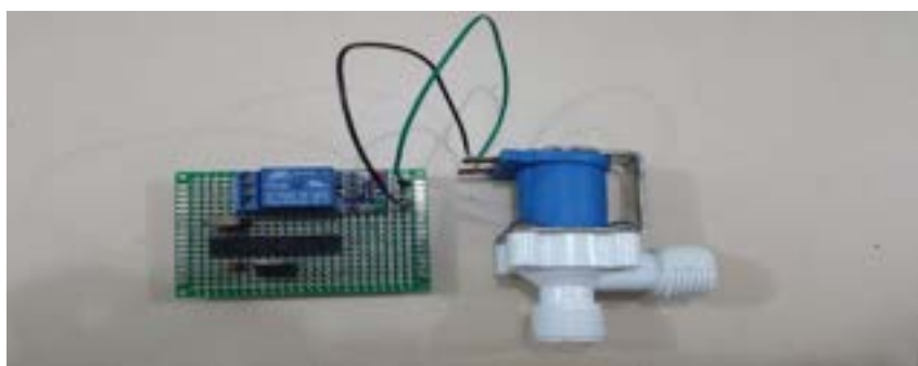
Figura 3. Mostra o projeto final em Placa de Circuito Impresso (PCB).
