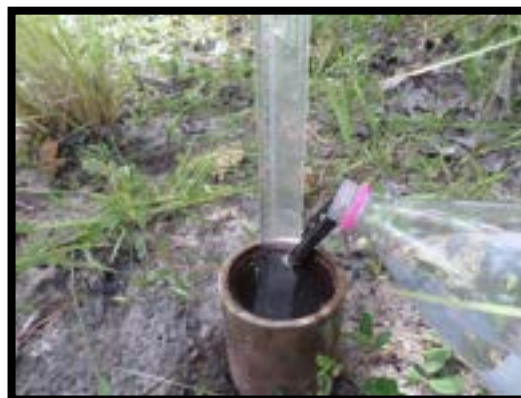
Figura 2. Mensuração da taxa de infiltração. Fonte: PORTELA, 2016.
