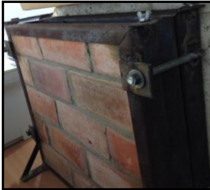
Figura 4 – Parede de alvenaria com cantoneira de aço.
