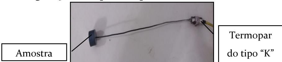
Figura 3: Termopar do tipo K inserido na amostra
