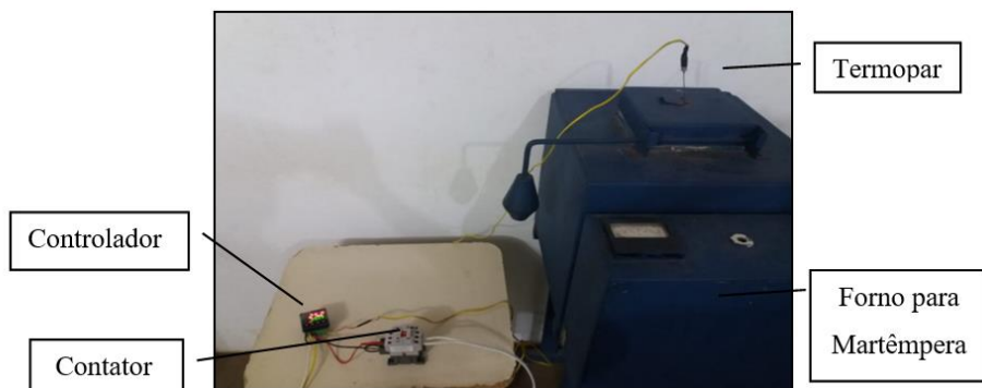
Figura 5: Monitoramento da temperatura do banho de estanho feita pelo controlador de marca Novus.
