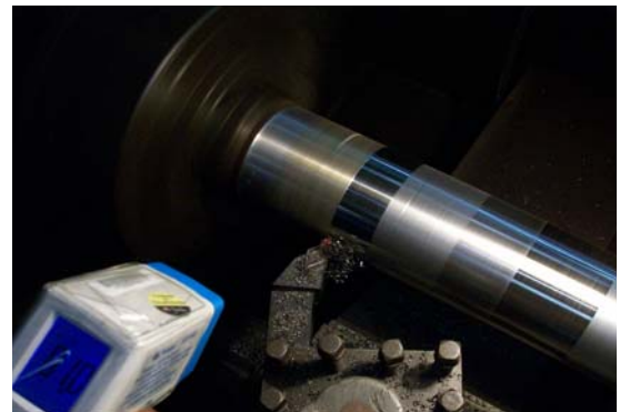
Figura 2. Usinagem a seco do aço ABNT 1045 a uma temperatura de 81°C
