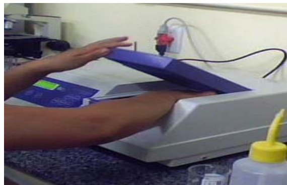
Figura 2 - Leitura das absorvâncias em espectrofotômetro a 595 nm
