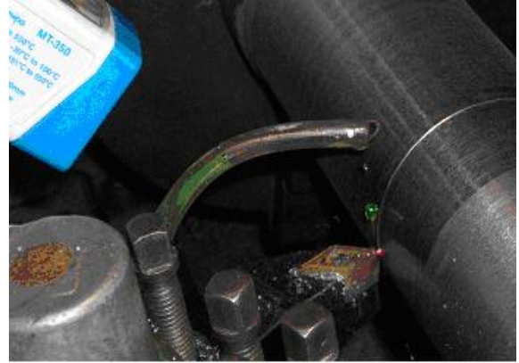
Figura 2 - Usinagem por gotejamento do aço ABNT 1045
