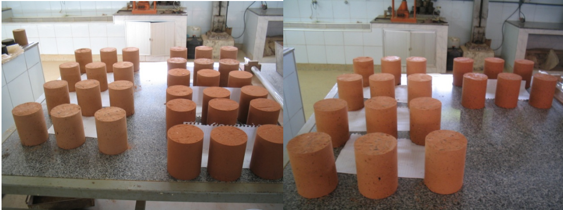
Figura 01: Corpos-de-prova solo-emulsão compactados
